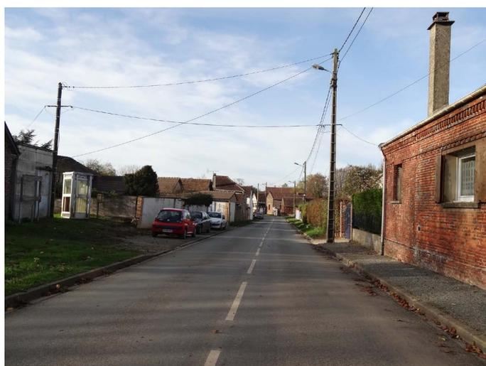
Sur les portions de lignes droites de la traversée, des «écluses routières» peuvent être installées en alternance pour forcer les véhicules à ralentir: le croisement des véhicules n'est pas possible et les espaces créent des poches de stationnement pour les résidents.
