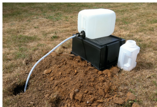
Test de perméabilité (Porchet)
